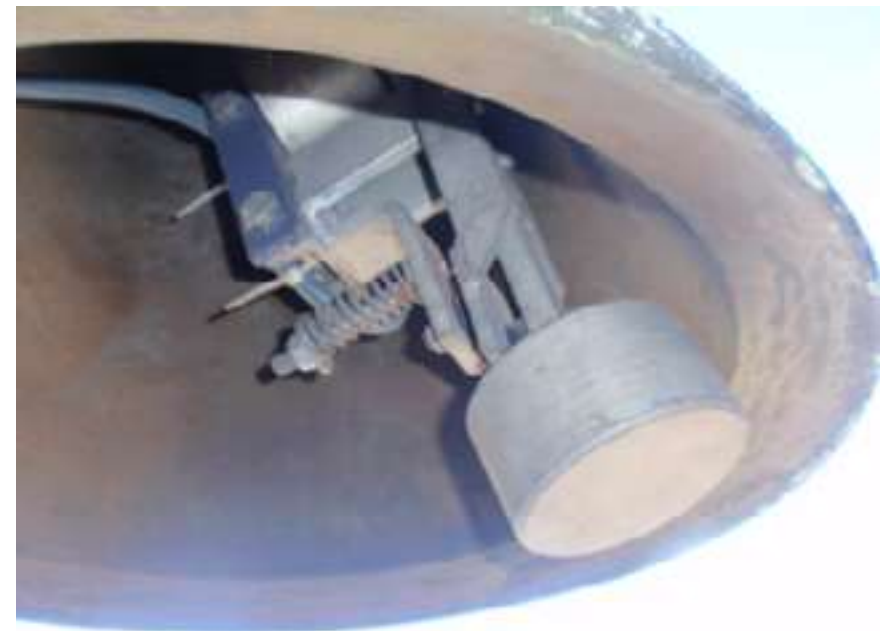
Badajo con mecanismo electrónico. Campanas núm. 1, 2 y 3. Iglesia de Ntra. Señora de la Altagracia
